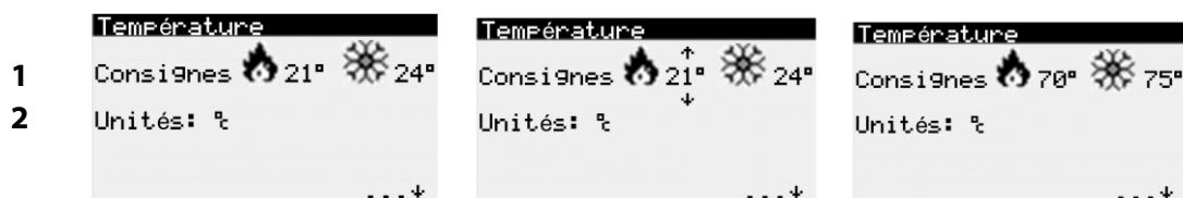
Figure 31 - Exemples du raccourci de réglages de la température de consigne et unités.
