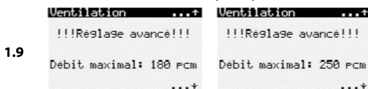
Figure 39 – Exemples d'options de réglage pour le débit d'air maximal.
