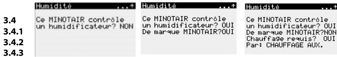
Figure 51 - Exemples d'options de réglages d'un humidificateur.
