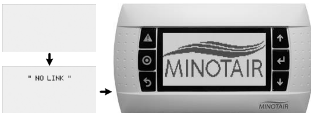
Figure 27 - Écrans de la séquence de démarrage de 30 secondes.
