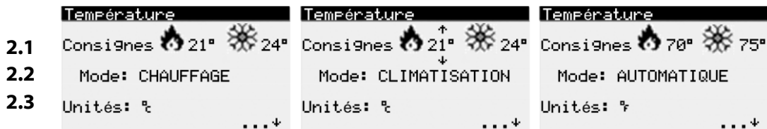
Figure 42 - Exemples d'options de réglages de la température de consigne, mode et unités.
