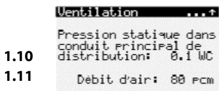
Figure 41 – Pression statique selon le débit d'air actuel.
